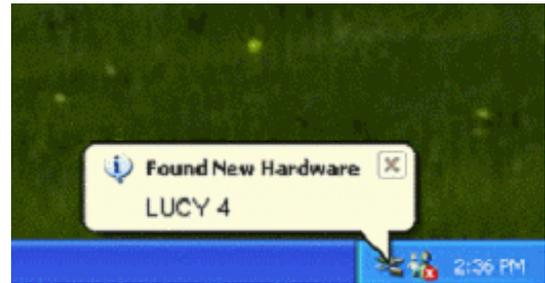
LUCY zeichnet sich durch eine komplexe Struktur aus. Wird LUCY zum ersten Mal angeschlossen, erkennt der PC vier unterschiedliche Geräte: ein Kombinationsgerät, eine Tastatur, eine Maus und schließlich ein Datengerät.
